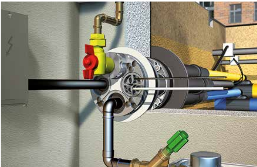
MSHE bei unterkellerten Häusern – alle Leitungen werden gebündelt durch eine Wandöffnung in den Keller geführt
